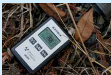
Le compteur Geiger apporté d'Europe. Au même endroit, un compteur japonais, acheté récemment donnait des valeurs de moitié.
